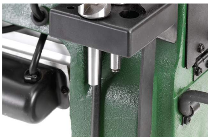
Magazynek. Tokarka DML 305 jest dostarczana z podręcznym magazynkiem na narzędzia.
