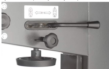
System szybkiego naciągu taśmy w modelach 403 i 503
