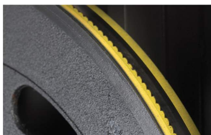
Nowy model nakładki gumowej na kołach prowadzących taśmę zwiększający wydajność i walory użytkowe
