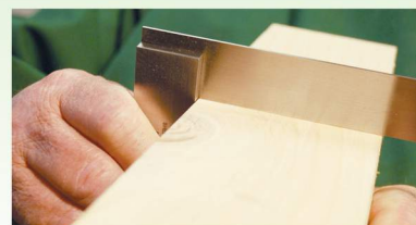
Kiedy uzyskamy kąt 90° względem sąsiadujących krawędzi, pozostałe boki strugamy na grubościówce, używając przygotowanych wcześniej powierzchni jako bazy do dalszej obróbki.
