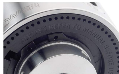
Uszczelniona tylna tarcza z 72 punktami indeksującymi
