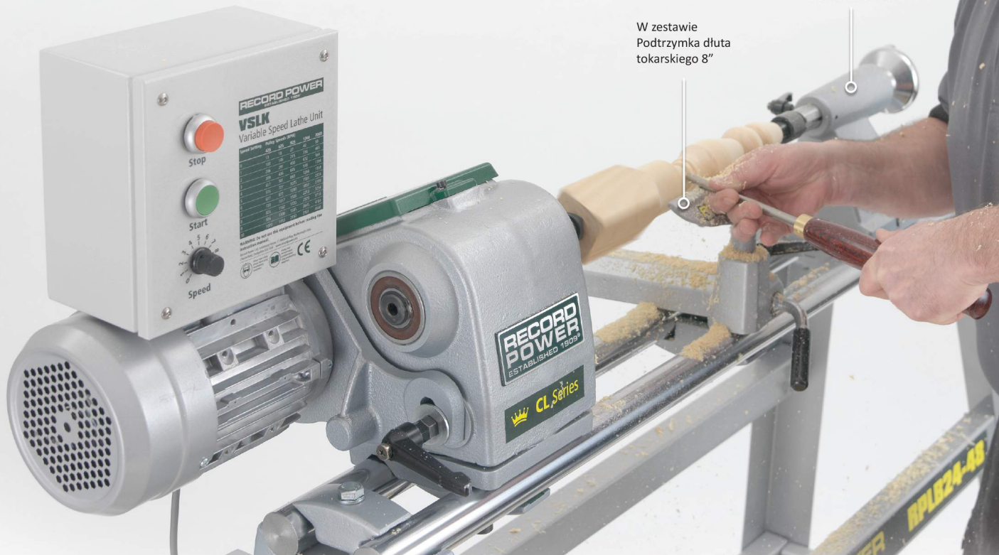
Wrzeciennik wyposażony jest w gwint M33 i zamknięte, nie wymagające konserwacji łożyska.
