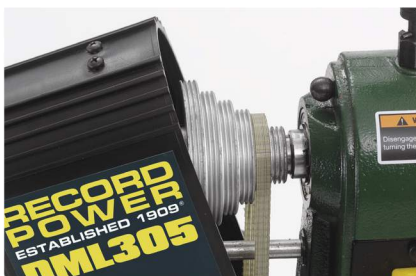
Wrzeciennik. Łatwy dostęp do kół pasowych i prosta zmiana prędkości tokarki. Wrzeciennik jest także wyposażony w system indeksujący.
