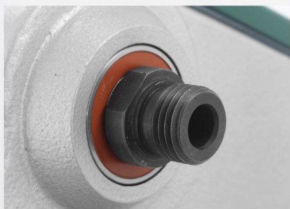
Wrzeciennik wyposażony jest w gwint M33 i zamknięte, nie wymagające konserwacji łożyska.
