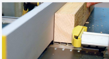
Wyrównać powierzchnię C przy ograniczniku, ustawionym pod kątem 90°, a następnie tak długo wyrównywnywać powierzchnię B aż uzyskamy kąt 90° względem powierzchni C .
