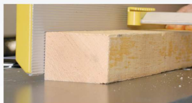
Wyrównać powierzchnię C przy użyciu wyrówniarki.
