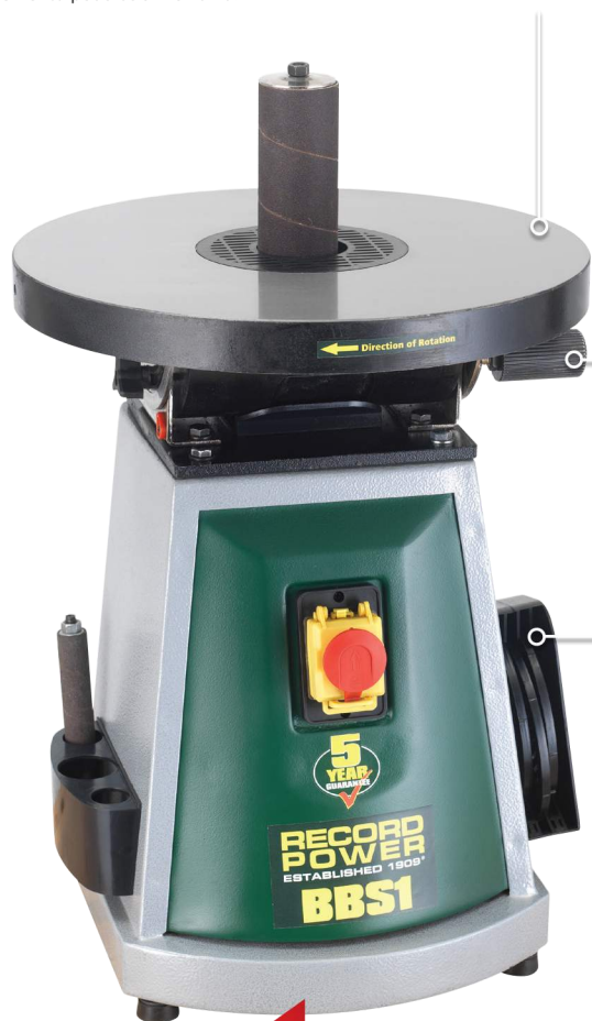
Oscylacyjny ruch wrzeciona w pionie eliminuje ryzyko palenia elementu podczas szlifowania.
