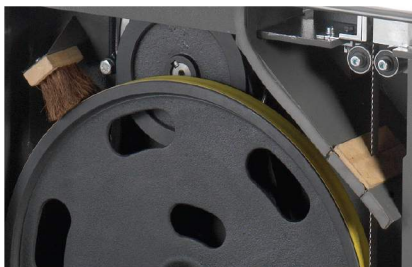
Dolne masywne koła z nakładkami gumowymi; mocowanie silnika i regulacja naciągu paska
